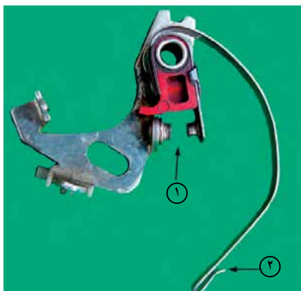
۱- پلاتین‌های مثبت و منفی ۲- محل اتصال پلاتین به سیم خازن دلكو
