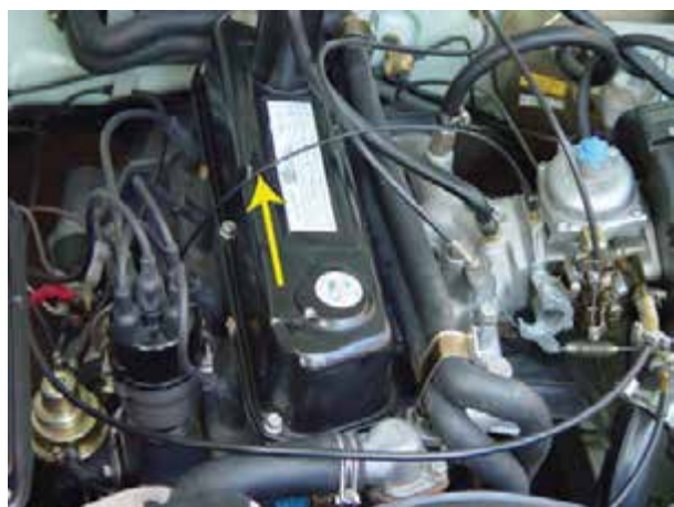
شکل ۲۸- ۱۰- لوله‌ی رابط آوانس خلئی به کاربراتور
