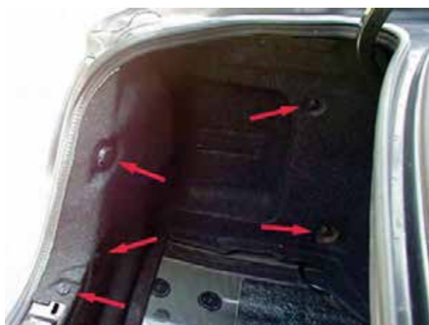
شکل ۵-۲۰- خارهای پلاستیکی کاور صندوق عقب
