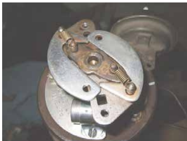
شکل ۲۴-۱۰- دستگاه آوانس وزنه‌ای دلکو
