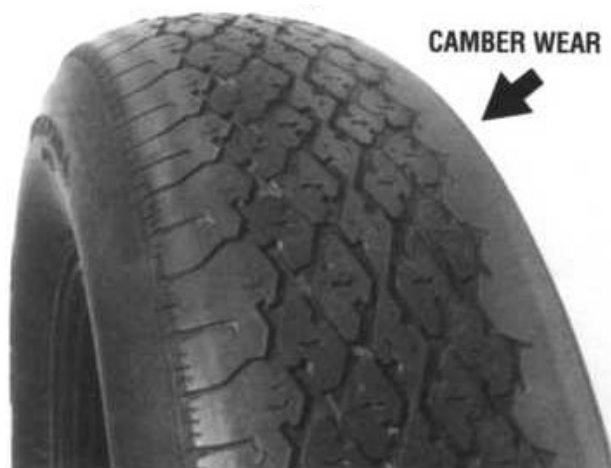
شکل ۲-۴۸. کمبر مثبت زیاد سبب سایش بیش از اندازه در لبه‌ی خارجی تایر شده است.
