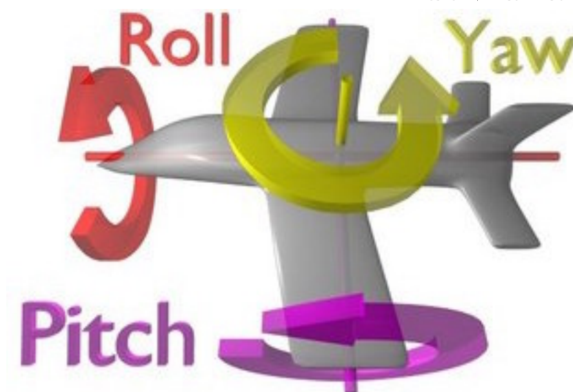
شکل ۲-۴۵. برخی از حرکت‌های دینامیکی مشابه با خودرو در هواپیما
