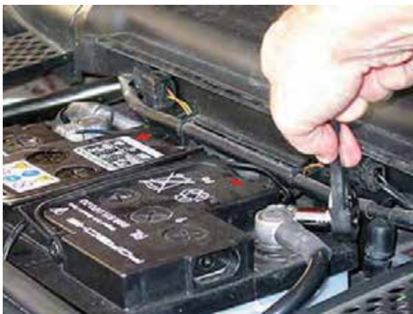
شکل ۱۸-۵- باز کردن کابل اتصال بدنه‌ی باتری
