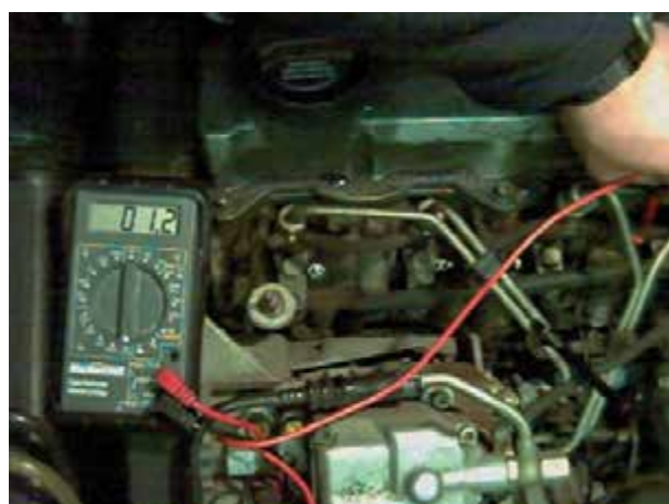
شکل ۲۳-۱۳- اندازه‌گیری مقاومت شمع گرم‌کن سیلندر چهارم
