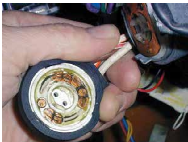
شکل ۱۱-۱۴- ترمینال داخل فیبری سوئیچ
