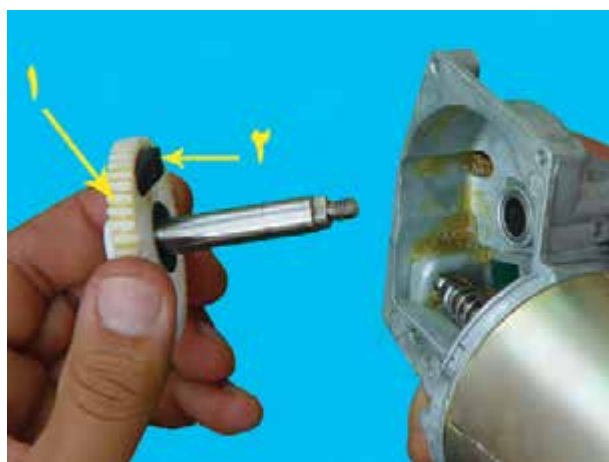
۱- چرخ دنده ۲- بادامک محرک زائده پلاتین
