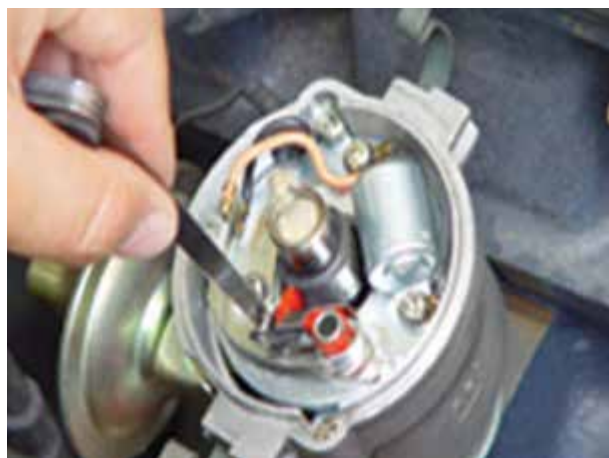
شکل ۴۸-۱۰ قرار دادن فیلر در دهانه‌ی پلاتین
