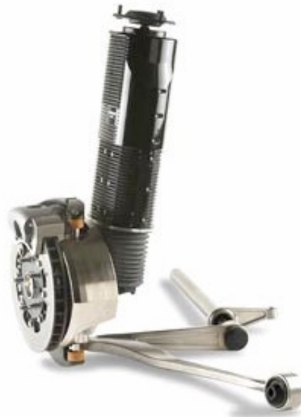
شکل ۲-۴. مجموعه‌ی تعلیق یک طرف خودرو در جلو
