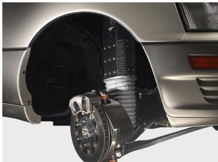
شکل ۲-۴. نحوه‌ی نصب سیستم تعلیق بُس در جلو به قاب موتور
