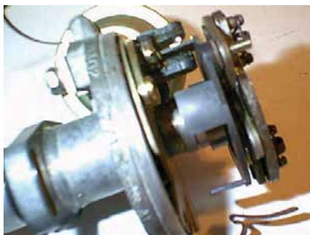
شکل ۷۳-۱۰- دلکوی الکترونیکی با حسگر اثرهال
