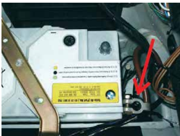
شکل ۹-۱۱- باز کردن کابل اتصال بدنه ی باتری
