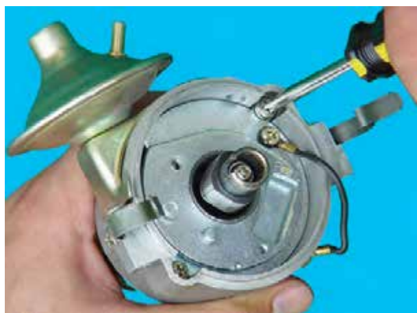
شکل ۱۹-۱۰- باز کردن پیچ‌های صفحه‌ی دلکو
