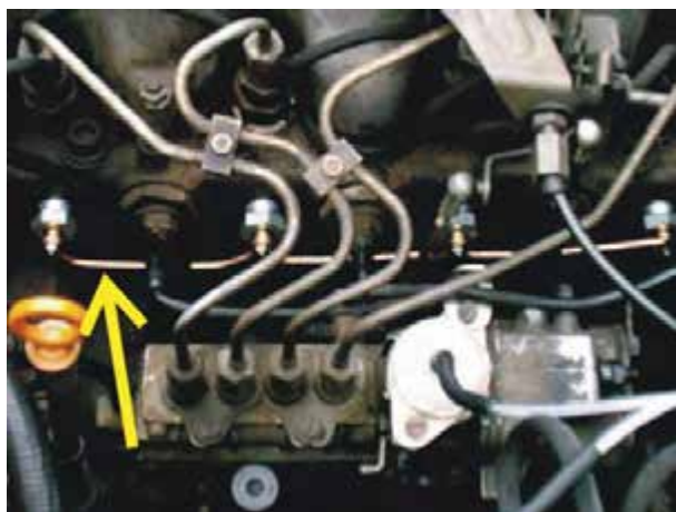
شکل ۷-۱۳- اتصال سری شمع گرم کن
