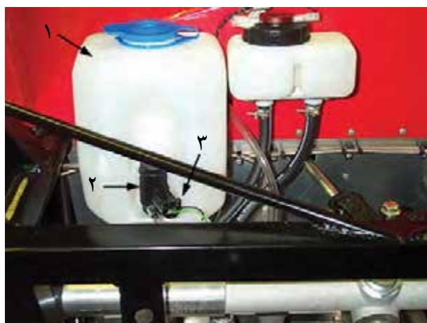
شکل ۷-۲- مخزن و پمپ آب شیشه‌شوی
