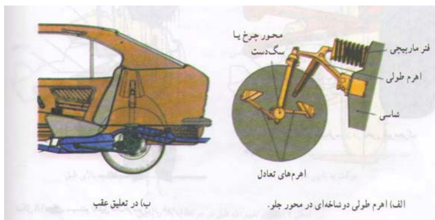
شکل ۲۰- کاربرد اهرم طولی در تعليق جلو و عقب
