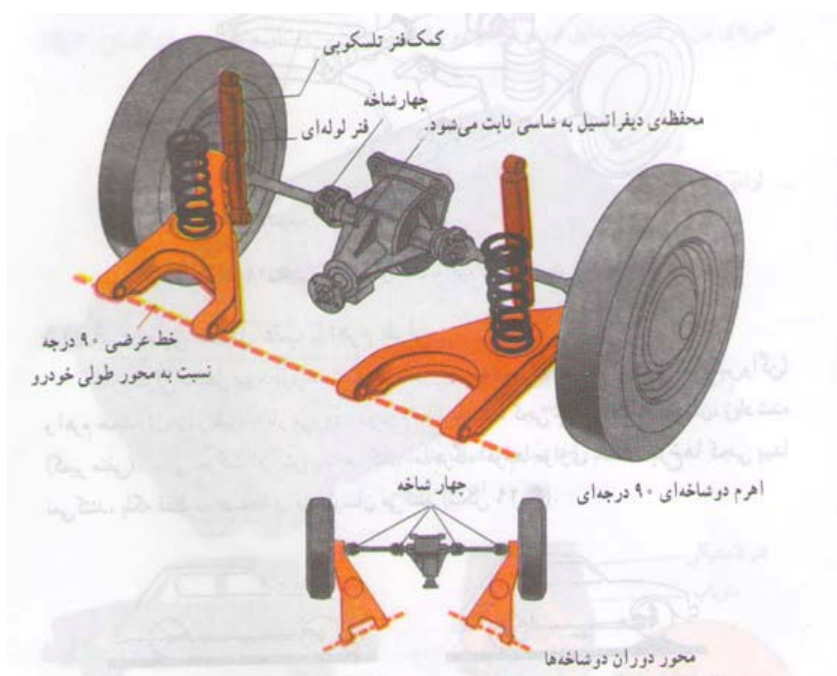
شکل ۲۷- اهرم دو شاخه ای با زاویه کمتر از ۹۰ درجه
