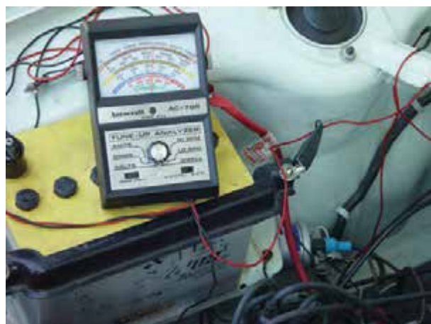
شکل ۱۳-۱۰- مقادیر زاویه‌ی نشست پلاتین (داول)
