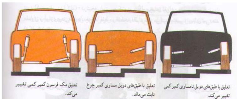
شکل ۱۶- سه نوع تعلیق و نحوه تغییرات کمبر در آنها
