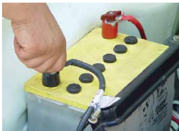
شکل ۱-۴۹- باز کردن اتصال بدنه باتری
