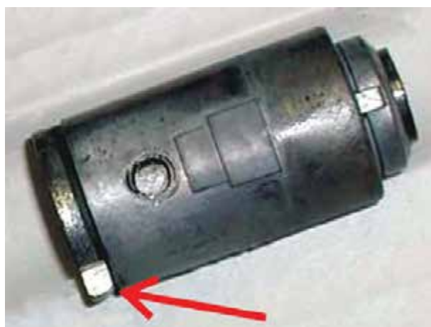
شکل ۱۹-۱۱- مغزی سوئیچ اصلی موتور
