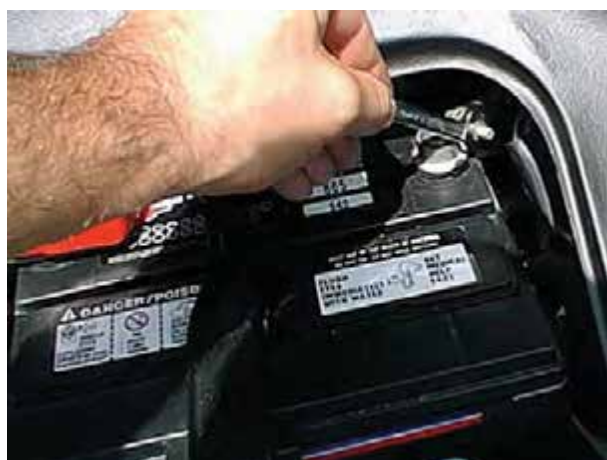
شکل ۱۲-۳ بستن کابل اتصال بدنه‌ی باتری
