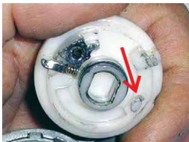
شکل ۲۵-۱۱- آسیب دیدن تکیه‌گاه فنر در روی فیبری سوئیچ
