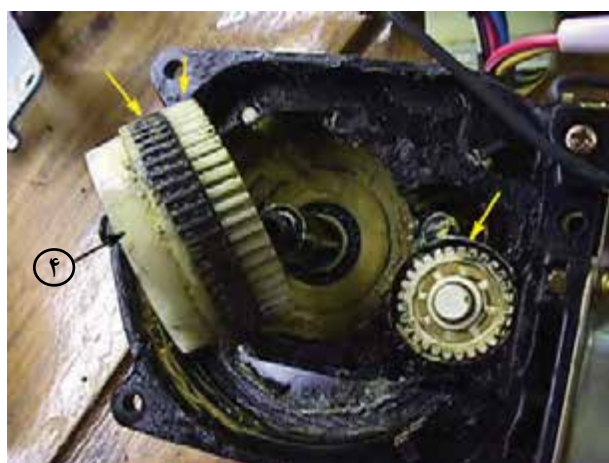
۱- چرخ دنده روی محور موتور الکتریکی ۲- چرخ دنده واسطه روی کلاچ ۳- چرخ دنده محرک تسمه دندانه دار میله آنتن ۴- کلاچ
