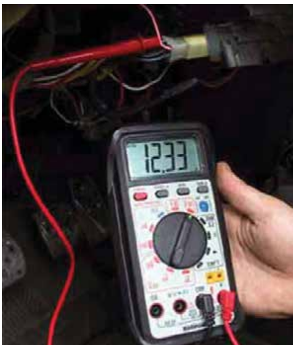
شکل ۲۸-۱۱- اندازه‌گیری ولتاژ در ترمینال ورودی سوئیچ
