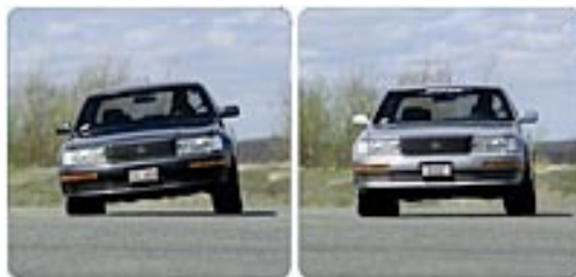
شکل ۲-۴۴. عملکرد سیستم تعلیق بس (سمت راست) در مقایسه با سیستم‌های معمولی (سمت چپ)
