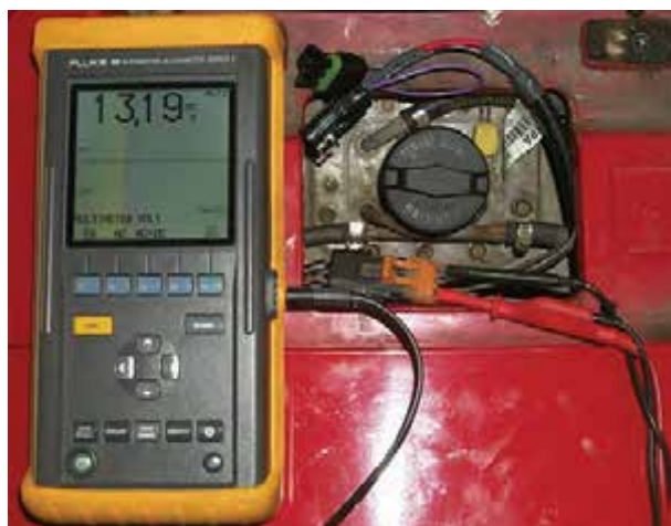
شکل ۸-۴۶ - اندازه‌گیری ولتاژ مدار
