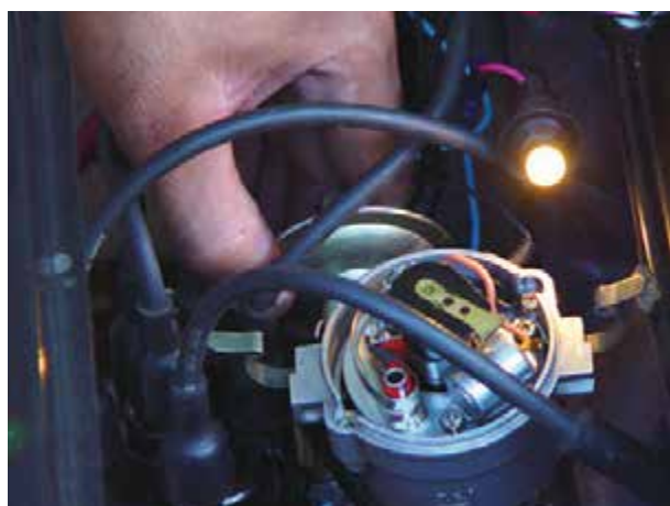
شكل ۶۰-۱۰ - لحظه‌ی باز شدن دهانه پلاتين و روشن شدن لامپ
