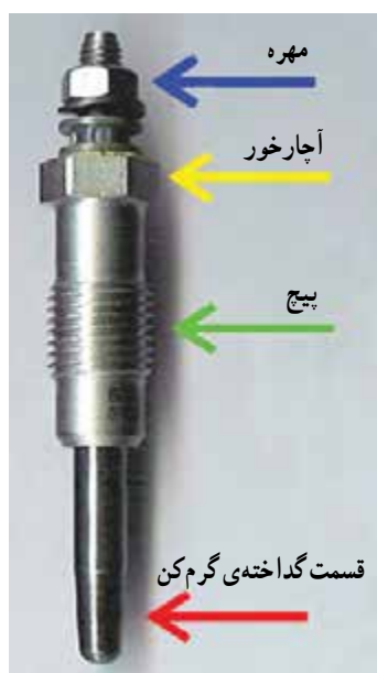
شکل ۱۳-۲- شمع گرم کن موتور دیزل
