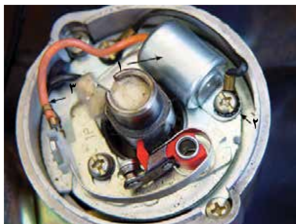
۱- خازن ۲- پیچ اتصال بدنه خازن ۳- سیم مثبت خازن شکل ۱۷-۱۰
