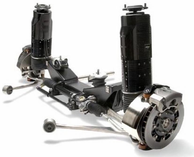
شکل ۲-۴۲. مجموعه‌ی کامل سیستم تعلیق بُس در جلو
