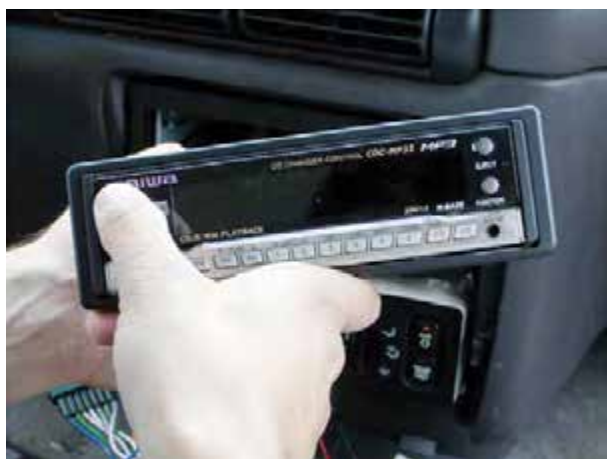
شکل ۴-۲۸- خارج نمودن رادیوپخش از داخل قاب کشویی
