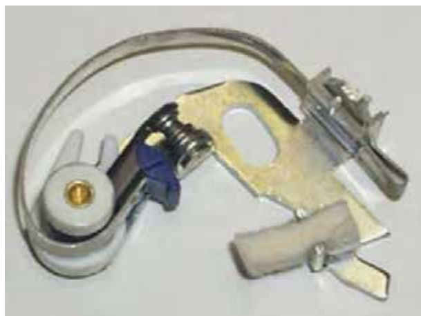
شکل ۲۲-۱۰- نمد روغن کاری بادامک
