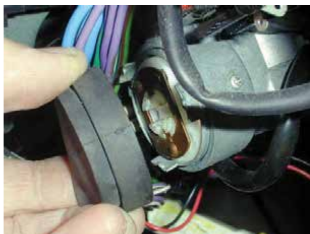
شکل ۱۱-۱۳- بیرون آوردن فیبری پشت سوئیچ
