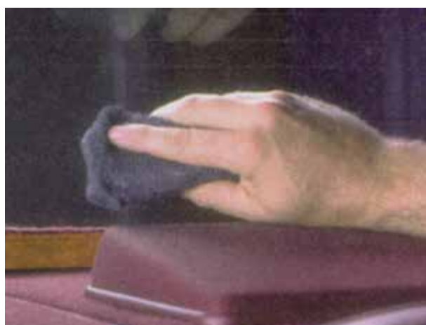
شکل ۳-۲۲- تمیز کردن محل قطع شده‌ی المنت حرارتی
