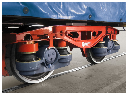
نمونه‌ای از فنرهای لاستیکی مورد استفاده در واگن‌های حمل بار
