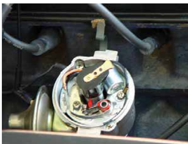
شکل ۵۵-۱۰- راستای چکش برق به سمت سیلندر یک
