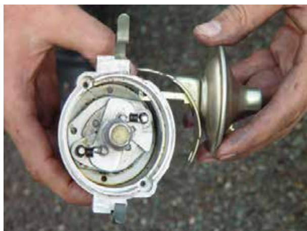
شکل ۳۱-۱۰ جدا کردن مجموعه‌ی آوانس خلثی
