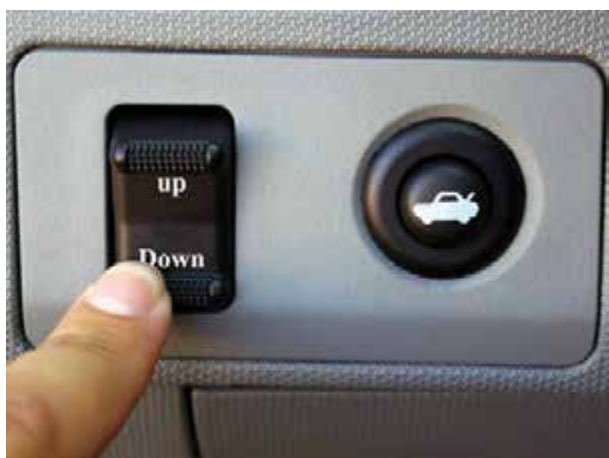
شکل ۵-۱۲- سوئیچ آنتن الکتریکی
