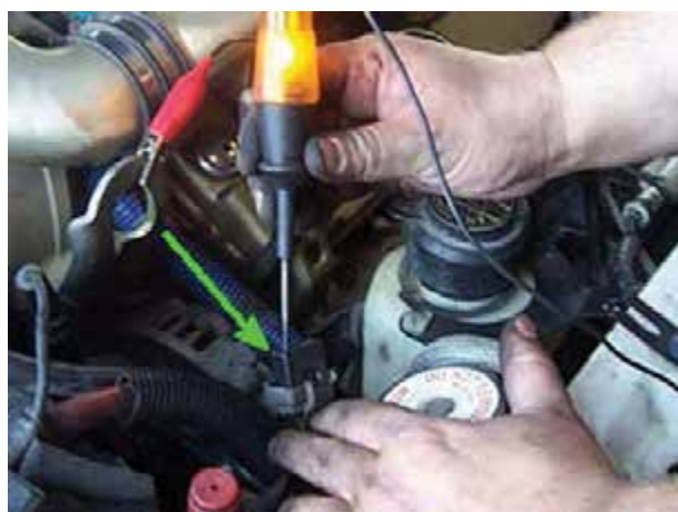
شکل ۱-۷۳- آزمایش سیم کشی مدار
