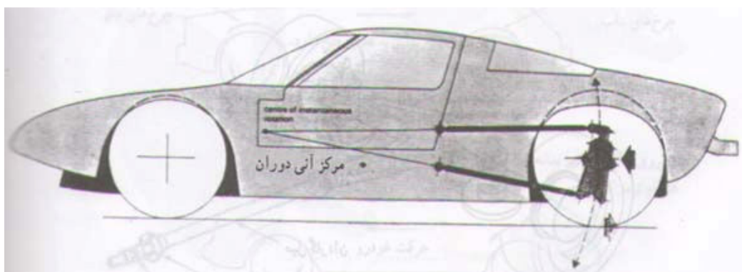
شکل ۷- مرکز آنی دوران یا مرکز کله زنی خودرو
