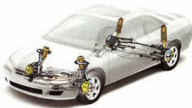
شکل ۲-۳۳. سیستم تعلیق دو جناغی هوندا آکورد
