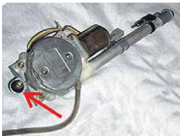
شکل ۵-۲۲- آنتن الکتریکی پس از پیاده کردن آن
